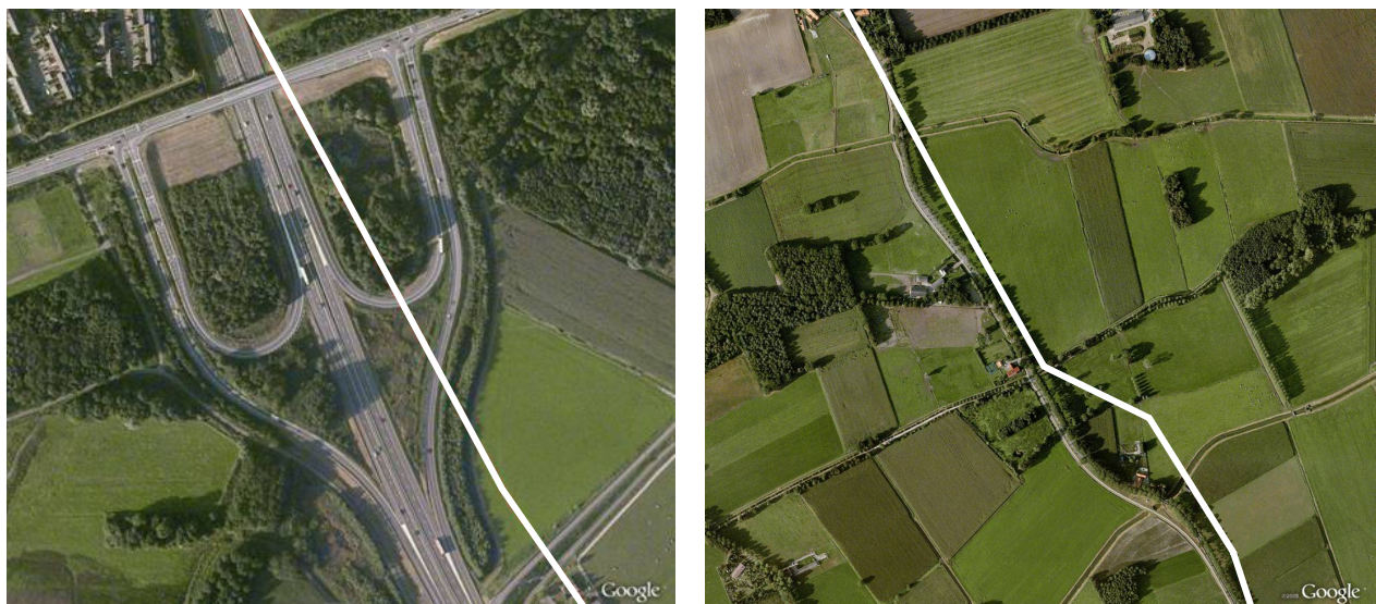
Figuur 6. Voorbeelden van afwijkingen tussen vectordata (bron Geodan) van een snelweg (links) en een provinciale weg (rechts) en dezelfde objecten in Google Earth.
